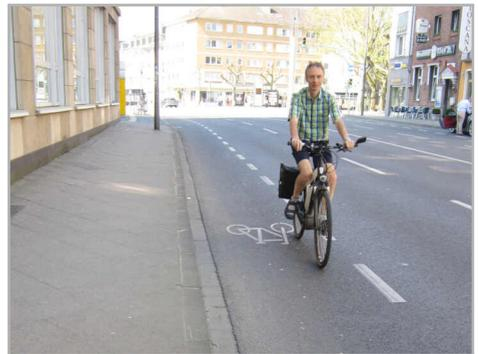
An diesem Beispiel sieht man, dass bei den typischen Aachener Schutzstreifen der Lenker bereits in die danebenliegende Kfz-Spur hineinragt, sobald Radfahrende den zulässigen Abstand zum Bordstein einhalten. Dies signalisiert aber gleichzeitig dem Autoverkehr »Hier passt Du auch mit
