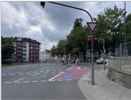
An der Kreuzung Bastei, auf der Krefelder Straße bergabwärts, wurde eine neue Fahrradampel eingerichtet. Dies nimmt einen Teil der geplanten kompletten Umgestaltung der Kreuzung vorweg. Zusätzlich zur Fahrradampel wurde eine eigene Rechtsabbiegeampel eingerichtet. Damit wird der rechts abbiegende Kfz-Verkehr signaltechnisch vom Radver-
